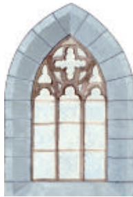
Rekonstruktion der Farbgebung an den Fensterleibungen in Grautönen mit aufgelegten schwarzen Fugen und Begrenzungslinie. Die Farbgebung wurde von dem Farbre Restaurator Markus Finkelnburg freigelegt.
